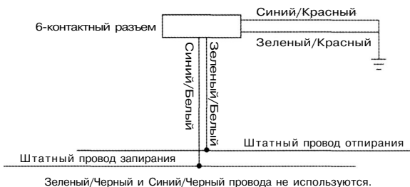
Схема 1. 3-проводная система с отрицательной полярностью (большинство японских автомобилей)
