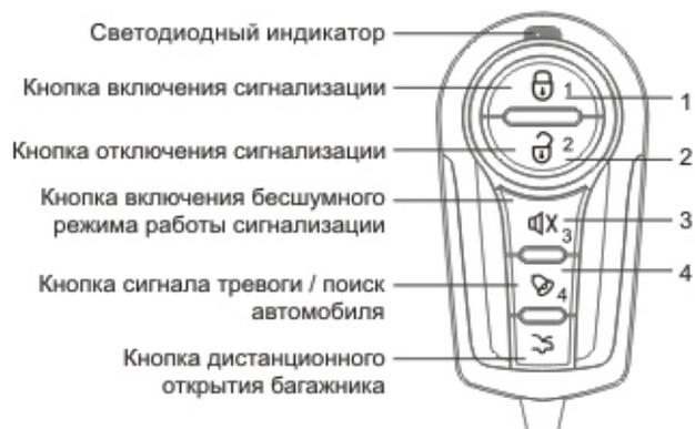
※ В режиме установки ПИН-кода нажмите цифровые клавиши (1,2,3,4) в любом порядке для установки ПИН-кода.
