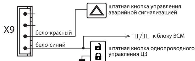
Выходы альтернативного управления активируются после выбора автомобиля (записи номера автомобиля в память автосигнализации). Активный управляющий уровень может быть как положительным, так и отрицательным (в зависимости от модели автомобиля). Предельно допустимый ток нагрузки на выходе – 200 мА. Информацию о возможности альтернативного управления и способах подключения Вы можете найти на сайте [www.starline-alarm.ru](http://www.starline-alarm.ru) в разделе «Поддержка».
