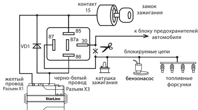
**Подключение встроенной цепи блокировки стартера**
