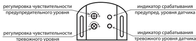
Первым настраивается предупредительный уровень. Для настройки необходимо открыть дверь автомобиля и включить режим охраны. Поочередно поворачивая регулировочный винт датчика по часовой стрелке и нанося легкие удары по кузову автомобиля (например на стыке рамок окон боковых дверей) добейтесь желаемого порога срабатывания. Аналогичным образом настройте тревожный уровень.
