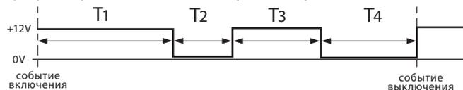
где: T1 - задержка первого импульса относительно события включения
