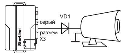
Мощность диода VD1 должна быть выбрана в соответствии с током потребления сирены. При подключении провода массы сирены необходимо обеспечить надёжный контакт.
