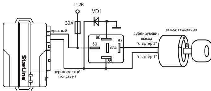
**Черно-желтый провод** — выход на стартер. Подключите к цепи замка зажигания, управляющей стартером.
