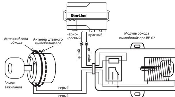
Для управления модулем обхода штатного иммобилайзера используется отрицательный выход сигнализации (черно-красный провод 18-контактного разъема «Х3»). Внутри модуля необходимо расположить ключ или чип ключа. Антенна модуля одевается на замок зажигания рядом с антенной штатного иммобилайзера. Если требуется подключить модуль обхода в разрыв антенны штатного иммобилайзера, то рекомендуем использовать схему включения, приведенную ниже:
