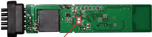
2. На 10 секунд подайте питание на реле. После отключения питания разомкните контактные площадки — теперь его снова можно прописать в автосигнализацию.
