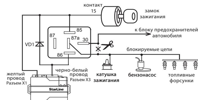
**Для нормально разомкнутого (НР) режима работы блокировки**
